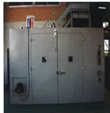
間熱ガス式乾燥炉例
