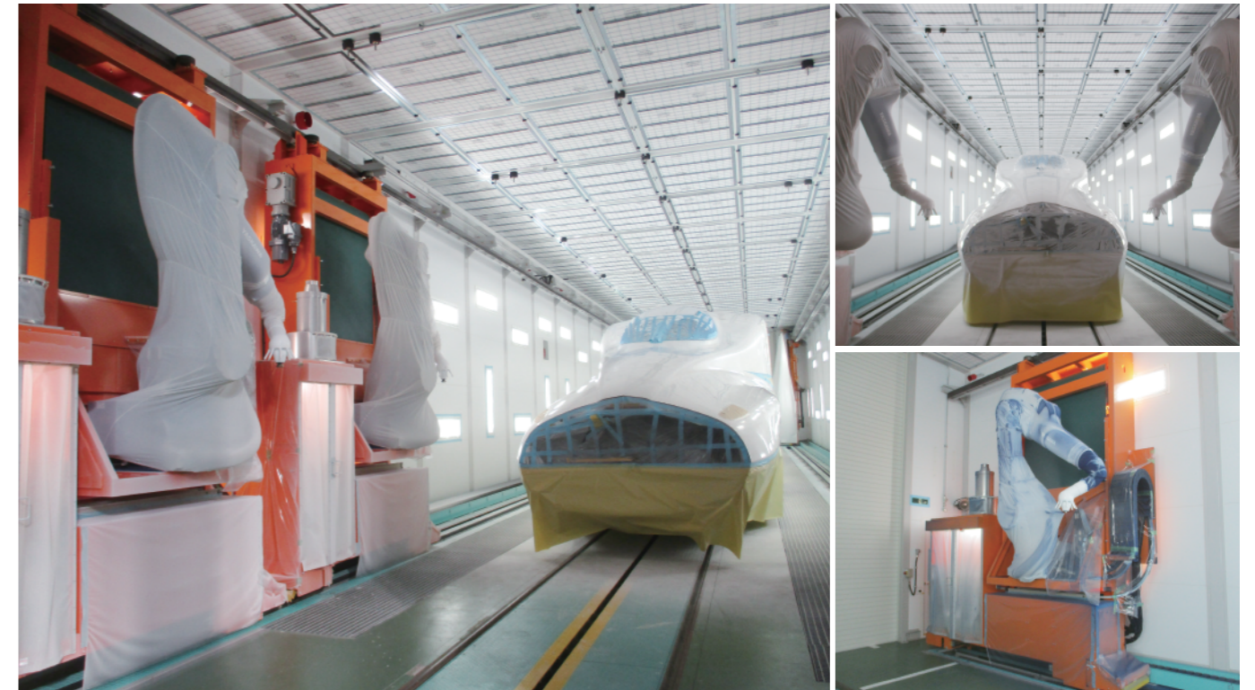
昇降走行付塗装ロボット設備
